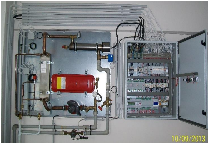
Фиг. 1 Лабораторен стенд на термопомпен агрегат въздух - вода
