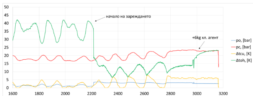
Фиг. 3 Работни параметри на водоохладящ агрегат
