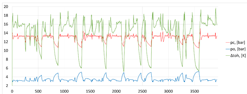
Фиг. 11 Работни параметри на хладилната система
