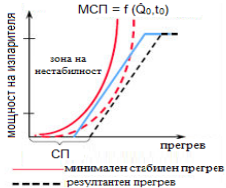
Фиг. 6 Пресичане на характеристика на TRV и МСП – линията [2]
